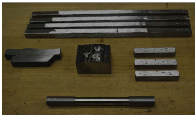
Slika 10 – Set za vrednotenje kemično-fizikalnih lastnosti testa, narejenega z mešanico plina UNI EN ISO 14175 M21
