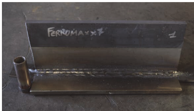
Slika 23 – Test, izveden po standardih UNI EN ISO 6947 PB z mešanico plinov Ferromaxx®7
