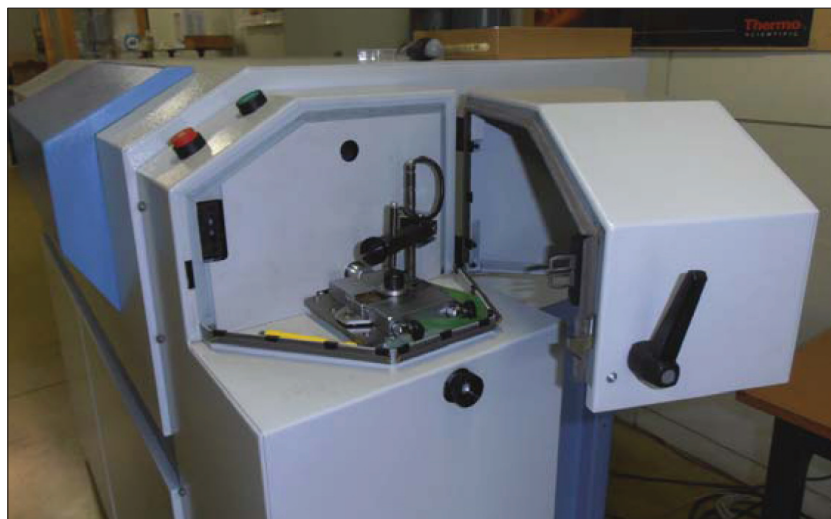
Slika 20 – Optični emisijski spektrometer za kemično analizo vzorcev
