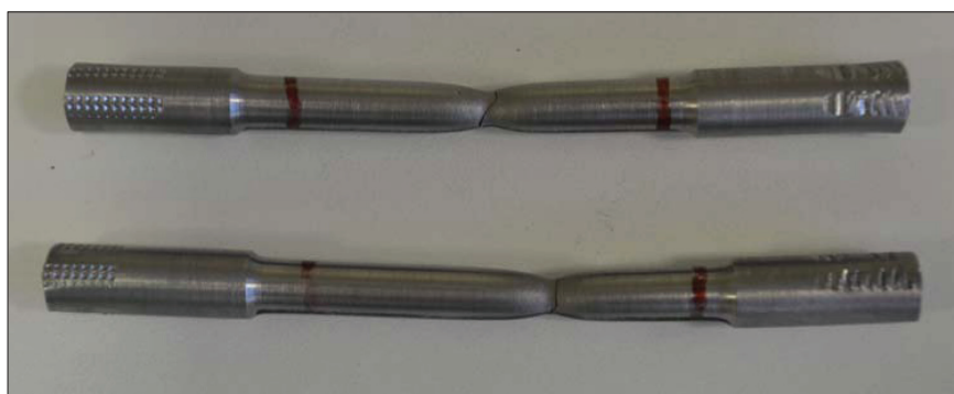
Slika 13 – Testni vzorci za tradicionalni longitudinalni preskus v spojeni točki
