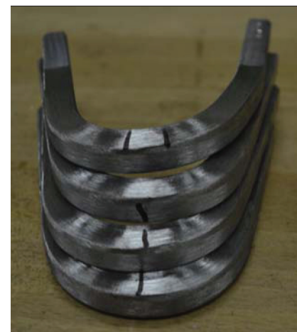
Slika 15 – Vzorci, pridobljeni iz raziskave z mešanico plina Ferromaxx®7, uporabljeni za testiranje stranske upogljivosti
