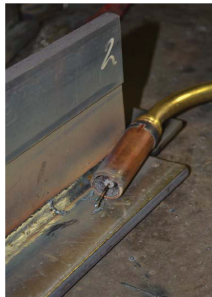
Slika 28 – Videz šobe po spoju z mešanico plinov M21
