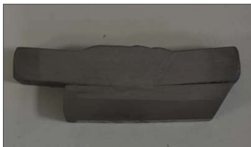
Slika 17 – Vzorec za izvedbo testa trdnosti pri raziskavi, opravljeni z mešanico plinov Ferromaxx®7
