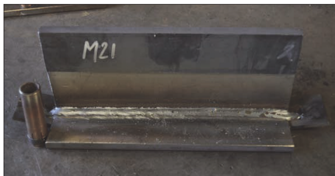
Slika 24 – Test, izveden po standardih UNI EN ISO 6947 PB z mešanico plinov UNI EN ISO 14175 M21
