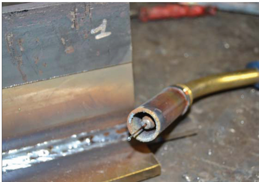
Slika 27 – Videz šobe po spoju z mešanico plinov Ferromaxx®7
